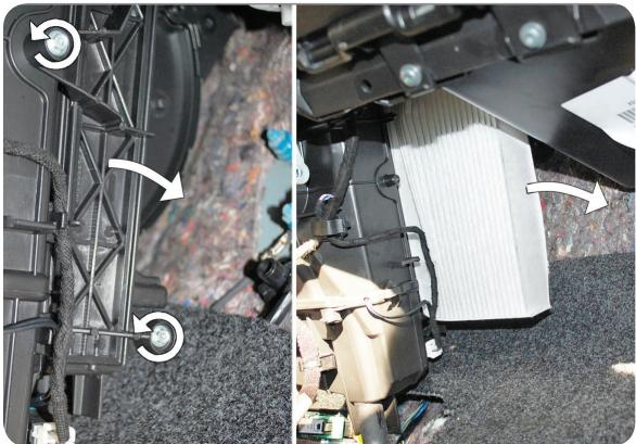
Allentare le viti che trattengono la copertura della camera filtrante.
