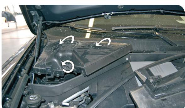
**IT** Allentare le viti che trattengono le schermature della copertura della camera filtrante
