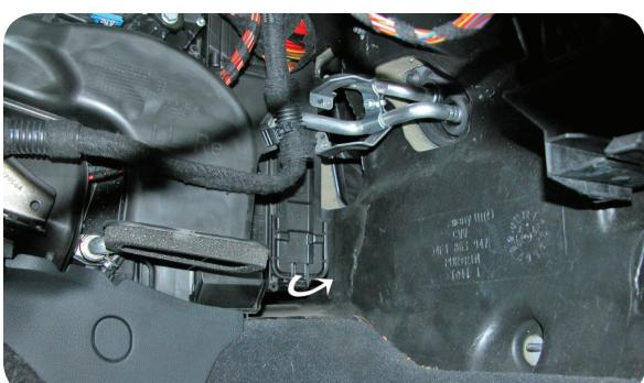
**IT** Rimuovere la copertura della camera filtrante
