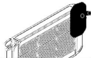
Wärmetauscher heat exchanger
