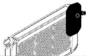
Wärmetauscher heat exchanger
