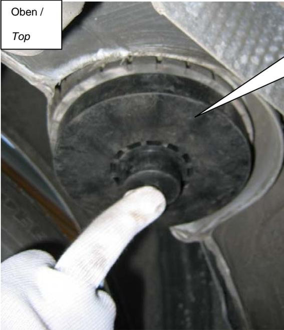
Der Spring Distance Kit wird oben zwischen Feder **und** Federunterlage montiert.
