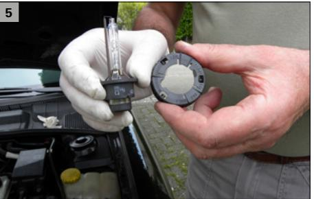
**DE** Lampenbefestigungsring durch kurze Linksdrehung öffnen und nach hinten ziehen.
