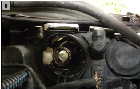
**DE** Neue Lampe in den Scheinwerfersockel einsetzen, dabei Führungsnocken beachten. Lampenbefestigungsring positionieren «Top/Oben» und vorsichtig im Uhrzeigersinn drehen.
