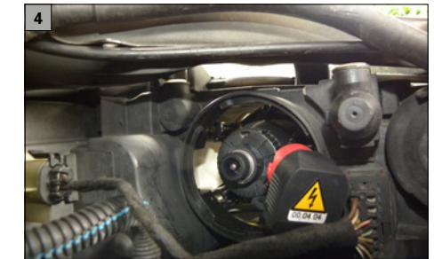
**DE** Hochspannungssteckanschluss im Gegenuhrzeigersinn drehen und abziehen.
