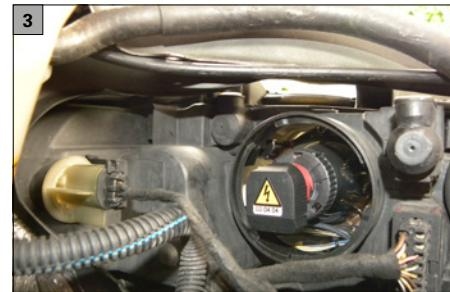
**DE** Abdeckklappe von dem Scheinwerfer entfernen.
