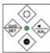
On/Off Taste für ca. 2 s gedrückt halten. Das Gerät schaltet sich ein. Auf dem Display werden alle zur Verfügung stehenden Segmente kurz angezeigt.
