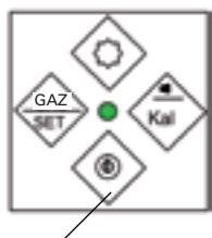
Mise en marche par activation de la touche (uniquement dans un environnement sans présence de gaz). Après la mise en marche, l'affichage LCD clignote pendant la phase d'échauffement qui dure env. 50 secondes alternativement entre H2 et HEAt. La barre analogique en bas de l'affichage augmente de la gauche vers la droite.
