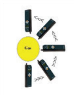
Dans la pratique, c'est la méthode de « palper » lentement le contour des raccordements qui a fait ses preuves. C'est ainsi qu'il est le plus probable de détecter une petite bulle de gaz qui s'échappe.
