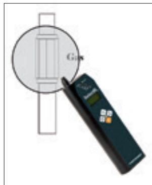
Un bref rapprochement aux raccords vissés ou au raccord à filetage à chanvre ne suffit pas pour détecter des petites fuites de gaz.
