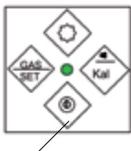
Einschalten durch Betätigen dieser Taste (nur in gasfreier Atmosphäre) Nach dem Einschalten blinkt die LCD-Anzeige während der ca. 50 Sekunden dauernden Aufheizphase im Wechsel zwischen H2 und HEAt. Der Analogbalken am unteren Rand der Anzeige baut sich von links nach rechts auf.
