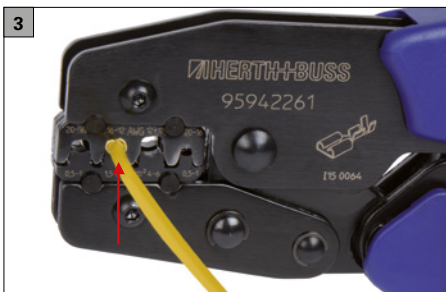
Korrekt abisolierten Leiter in den Kontakt einlegen.
