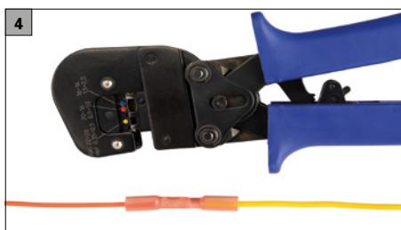
Les câbles doivent ensuite être sertis l'un après l'autre avec le connecteur. Dans cet exemple, notre pince de sertissage CrimPro10 est utilisée alternativement à la CrimPro30.
