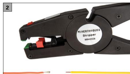
Il lui suffit de relier le câble de réparation au câble présent dans le véhicule (ici en jaune). Auparavant, les deux câbles doivent être dénudés (par exemple avec notre pince à dénuder).
