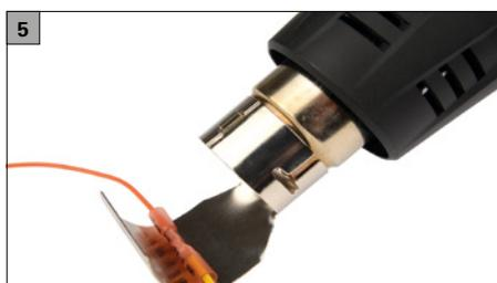
Abschließend erfolgt die Schrumpfung des Verbinder mithilfe eines Heißluftföns.
