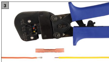
Pour la connexion, il est possible d'utiliser par ex. un connecteur à sertir ou un connecteur à rétraction. Ces connecteurs sont compris dans la livraison.
