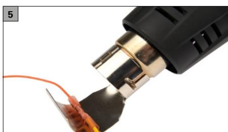
Le connecteur doit ensuite être rétracté à l'aide d'un sèche-cheveux.
