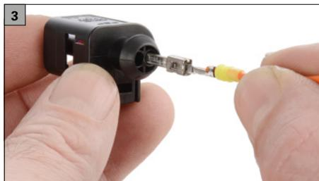
Reparaturkabel anschließend in das Gehäuse einführen.
