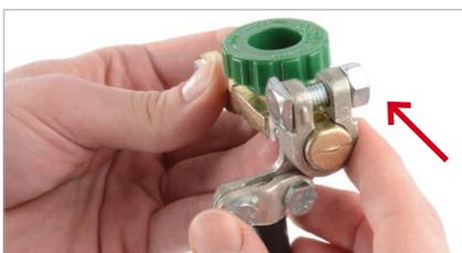
Die zuvor abmontierte Minusklemme nun an den Bolzen an der Unterseite der Quick Breaker-Klemme befestigen.
