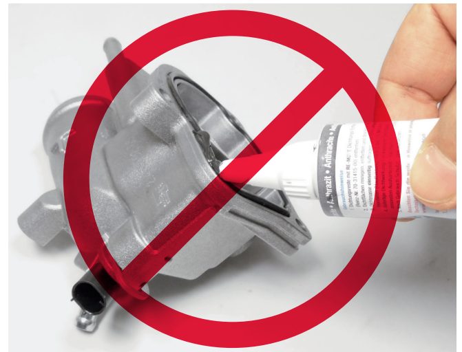
Abbildung 3: Zusätzliche Dichtmittel können Dichtungen beschädigen und die Funktion einschränken.
