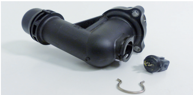
Abbildung 1: Kennfeldthermostat mit gelöster Halteklammer und abgerissenem Anschluss
