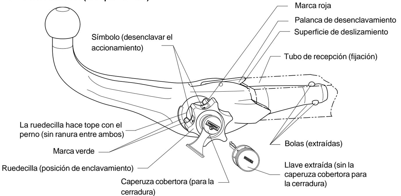
**Posición desenclavada (desmontado)**
