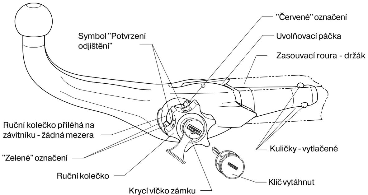
**Odjištěná pozice Vydání kulové tyče**
