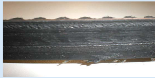
Ίχνη που παραπέμπουν σε υπερθέρμανση
