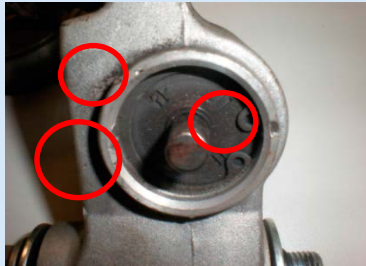
Φθορά στον τεντωτήρα
