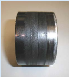
Ίχνη που παραπέμπουν σε υπερθέρμανση
