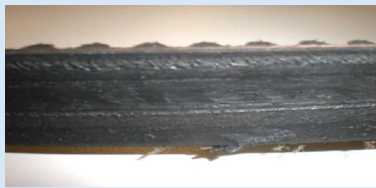
Známky přehřátí řemenice a poškození řemene způsobené nedodržením správného montážního postupu
