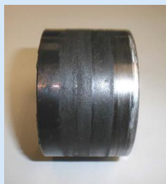
Známky přehřátí řemenice a poškození řemene způsobené nedodržením správného montážního postupu
