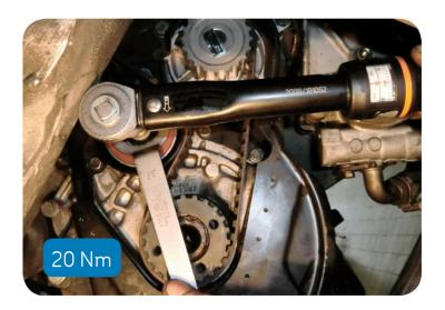
Compruebe que el engranaje del árbol de levas esta girando mientras se fija la tensión. Si no se realiza asi, entonces no se mantendrá la tensión correcta, y podrían producirse daños al motor.
