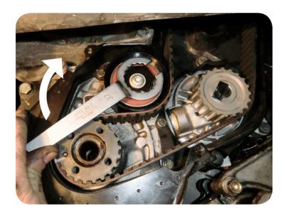
Utilizando la herramienta correcta, girar el regulador en dirección de las agujas del reloj hasta que el indicador este alineado con el centro de la placa trasera.
