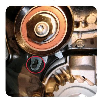
VKM 11072 y VKM 11257: Ajuste el tensor, asegurarse de que está correctamente emplazado en la chaveta. Apretar a mano para asegurar un correcto posicionamiento.
