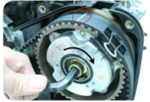
Resim 9: Kayışı klipsle sabitleyin ve zamanlama işaretini hizalayın
