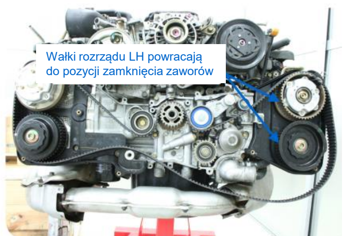
Zdj. 4: Po demontażu rolki A, napięcie paska zostaje poluzowane
