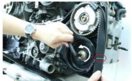
Εικόνα 9: Ασφαλίστε τον ιμάντα με τη χρήση ενός μεταλλικού και ευθυγραμμίστε τα σημάδια
