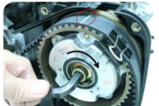
Εικόνα 9: Ασφαλίστε τον ιμάντα με τη χρήση ενός μεταλλικού και ευθυγραμμίστε τα σημάδια
