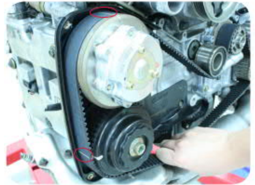
Εικόνα 8: Ευθυγράμμιση σημαδιών χρονισμού
