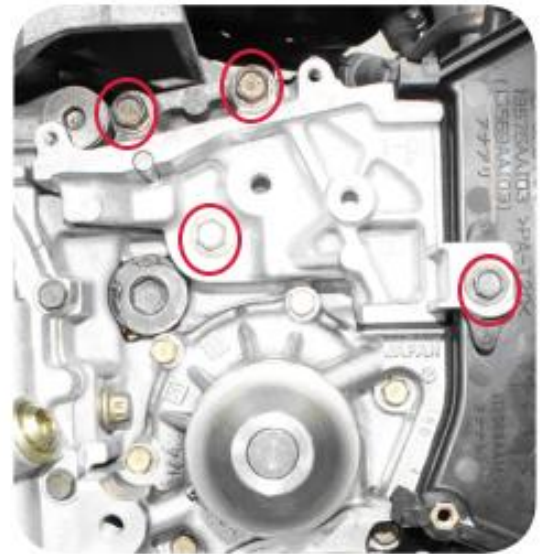
Obrázek 5: Šrouby zajišťující napínací jednotku
