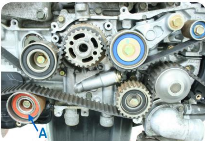
Obrázek 3: Načasování napínacích kladek a umístění napínáku
