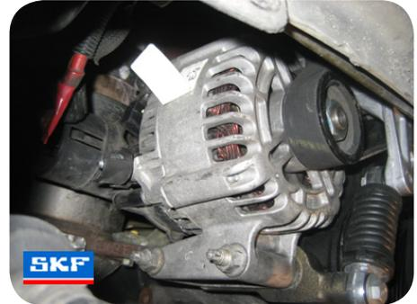
3. Extraiga el soporte del alternador con el tensor VKM 34032.
