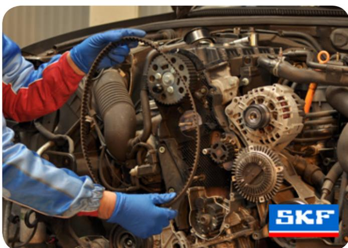
5. Χαλαρώστε το παξιμάδι του τεντωτήρα και περιστρέψτε τον τεντωτήρα αριστερόστροφα χρησιμοποιώντας το κατάλληλο εργαλείο.
