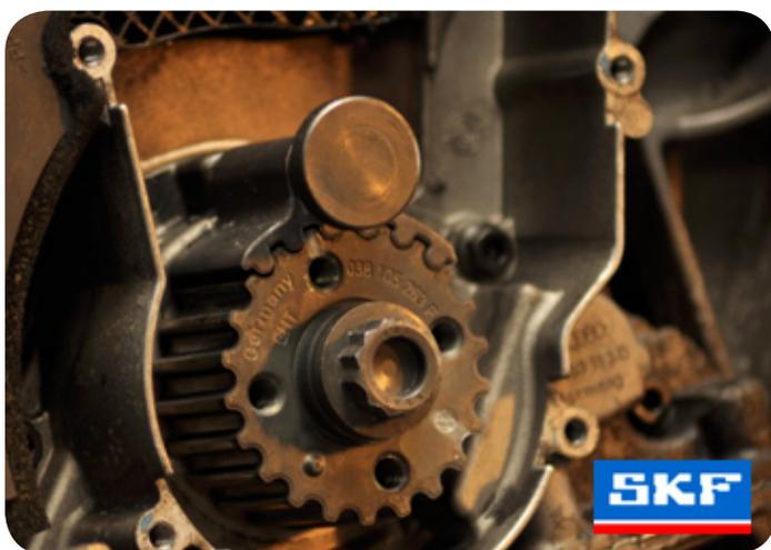
4. Ασφαλίστε τον οδοντωτό τροχό του εκκεντροφόρου και του στροφαλοφόρου χρησιμοποιώντας τα κατάλληλα εργαλεία.
