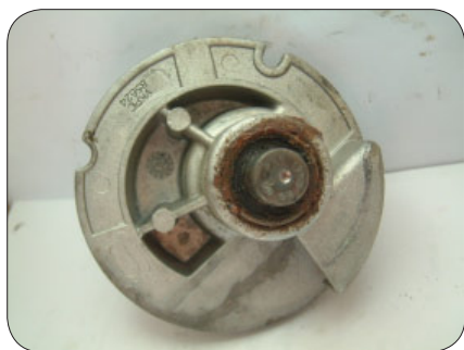
Przykładowe uszkodzenia pompy wody:
