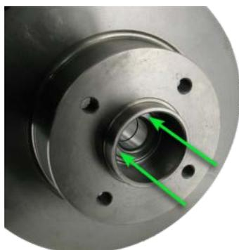
Quando si installa il cuscinetto ed il disco freno, applicare la forza SOLO sull'anello interno del cuscinetto.
