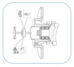
Desmontar el disco de freno, la tuerca y la tapa de montaje viejos. Nunca vuelva a usar la tuerca y la tapa antiguas.
