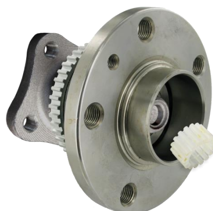
Tijekom pravilne montaže osovina će istisnuti plastičnu čahuru. Nemojte je vaditi prije montaže.
