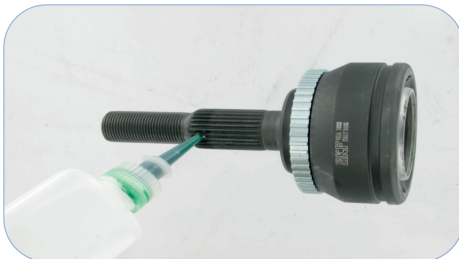
Bilde 1: Påføring av metallim
