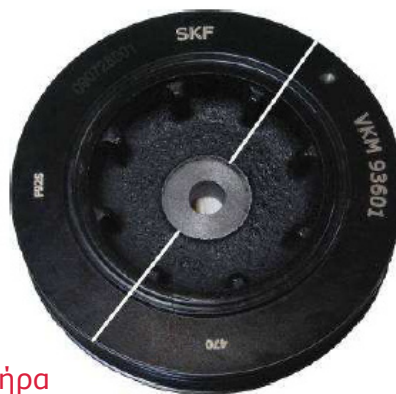
Φθαρμένος αποσβεστήρας - Χρειάζεται αντικατάσταση
