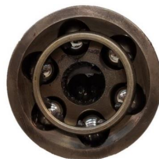
POSLIJE Tvornički podmazani homokinetički zglob
