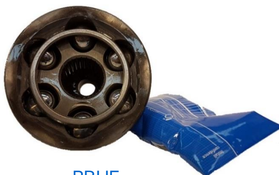
PRIJE Homokinetički zglob s plastičnim vrećicama maziva
