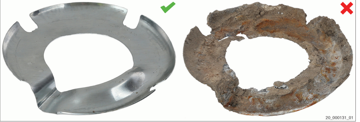
الشكل 3 أنود ذواب جديد | أنود ذواب مستعمل
