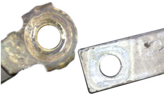
Sl. 1: Maska povezava pred čiščenjem: slab stik
