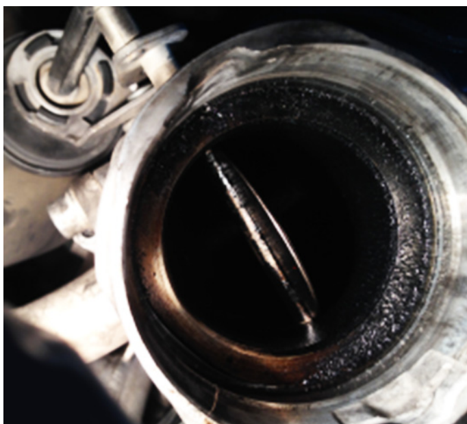
Фиг. 4: Коксирана клапа на вентила за рециркулация на отработените газове
