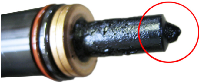
Фиг. 3: Коксиран елемент на дюзата на помпата
