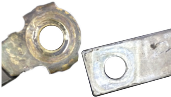
图示 1: 清洁前接地: 接触不良
