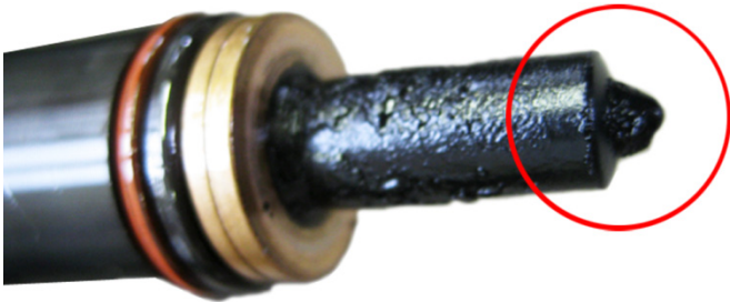
图示 3: 泵-油嘴元件焦化
