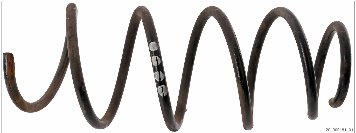
Εικ. 2 Μεταχειρισμένο ελατήριο ανάρτησης με έγχρωμο μαρκάρισμα (παράδειγμα)
