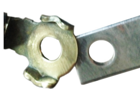
Rys. 1: Połączenie masy przed wyczyszczeniem: słaby kontakt Rys. 2: Połączenie masy po wyczyszczeniu: dobry kontakt
