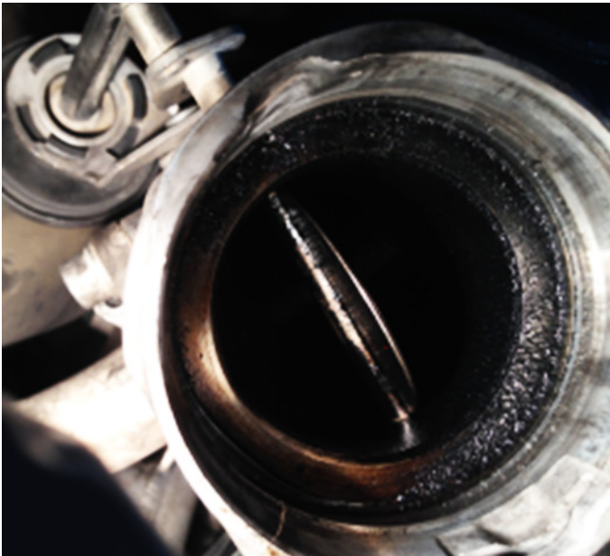
Rys. 4: Kłapa zaworu recyrkulacji spalin zanieczyszczona nagarem
