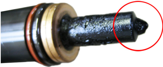
Obr. 3: Zakarbonovaný prvek čerpadlo-tryska
