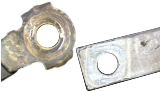
Obr. 1: Uzemnění před vyčištěním: Špatný kontakt
