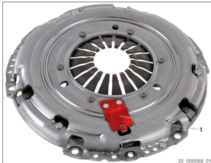
Obr. 7: XTend typ IV s aretačným plechom (zanitovaný)
