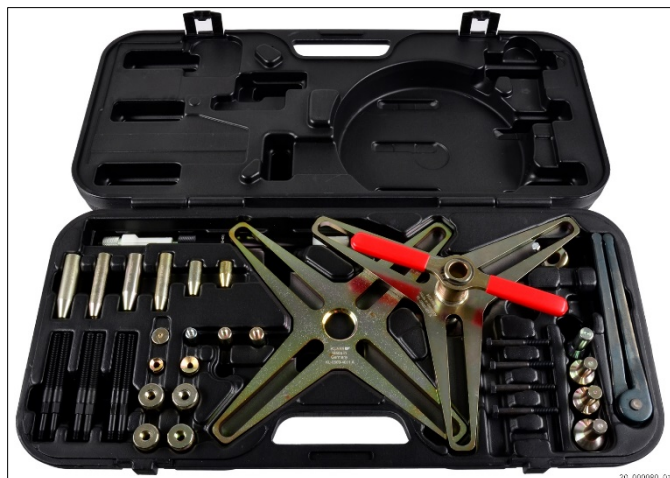
Obr. 8: Špeciálny nástroj: napínacie zariadenie s centrovacím trňom
