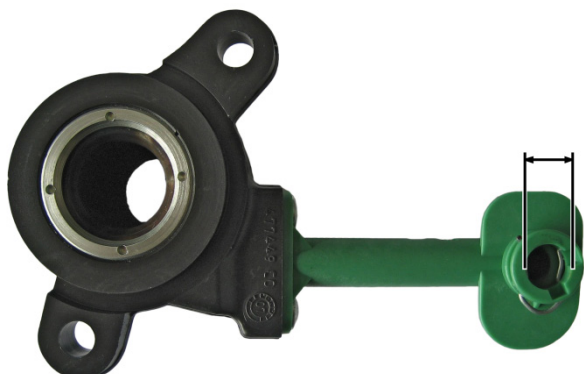
Kuva 1: CSC 3182 600 121 → 3182 654 165 Hydrauliikkaliitännän halkaisija 11,7 mm
