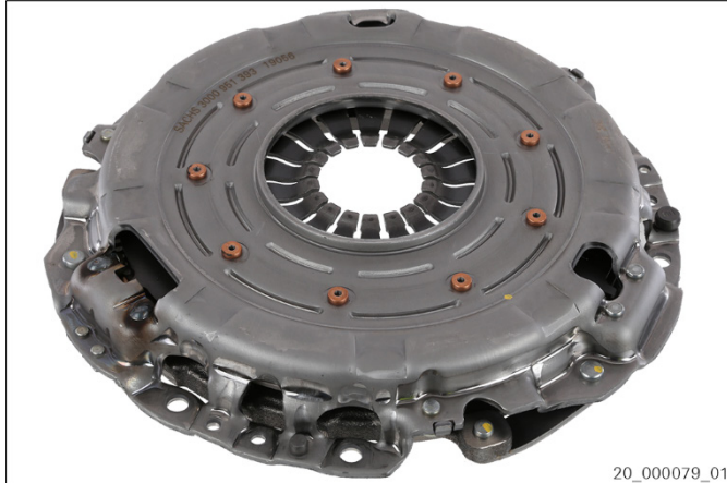
Kuva 4: XTend-kytkimen tyyppi III ilman lukituskappaletta
