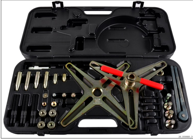
Kuva 8: Erikoistyökalu: kiinnitystyökalu ja keskitystuurna
