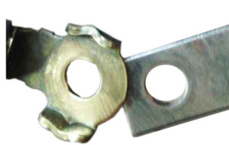
Kuva 2: Maadoitusliitos puhdistuksen jälkeen: kontakti hyvä
