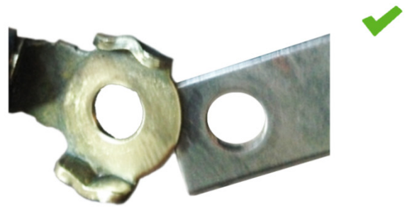
Kuva 2: Maadoitusliitos puhdistuksen jälkeen: kontakti hyvä
