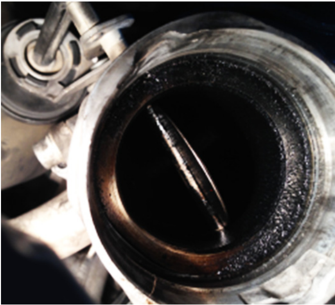
Bild 4: Ventil till avgasåterledningsventilen (EGR-ventil) förkolnad
