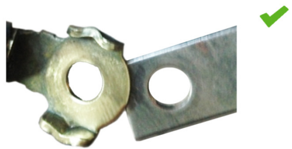
Bild 2: Jordförbindelse efter rengöringen: bra kontakt
