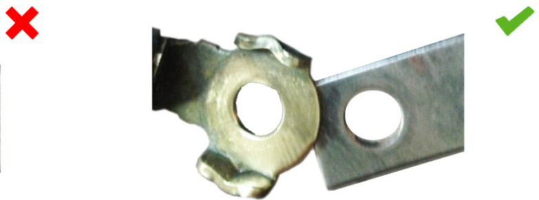
Afb. 2: Massaverbinding na de reiniging: contact goed
