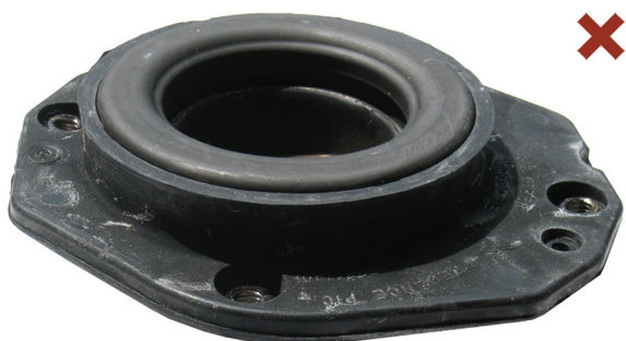
Fig. 1: Veerpootsteunlager verkeerd gemonteerd
