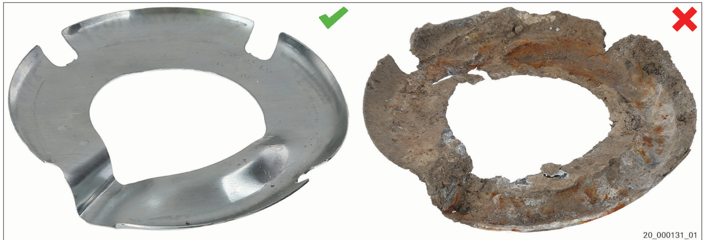
Fig. 3 Ánodo sacrificial nuevo | Ánodo sacrificial usado
