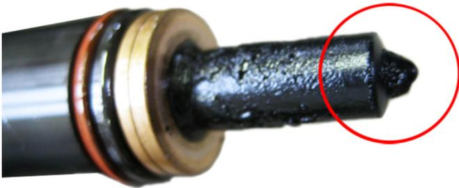
Fig. 3: elemento bomba-inyector carbonizado
