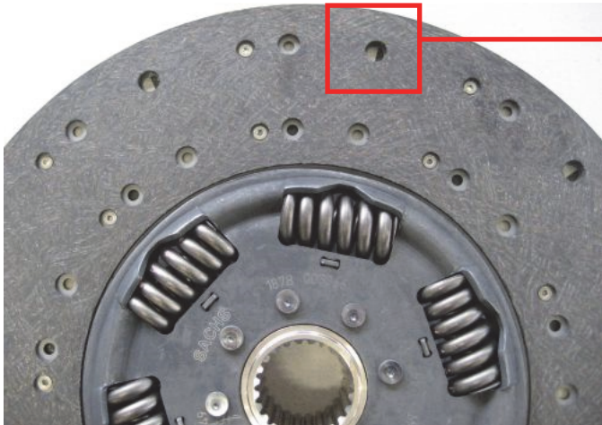
Fig. 1: Forro del lado del motor
