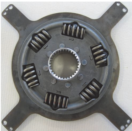
Fig. 2: Amortisseur de torsion de la prise de force.
