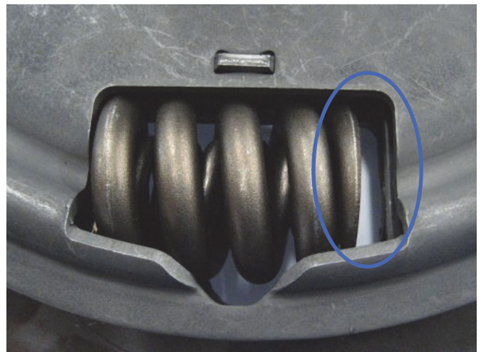
Fig. 3: Ressort de torsion avec jeu.
