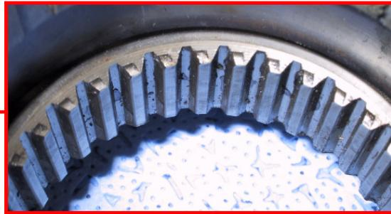
Esto sucede cuando los dientes del disco auxiliar no se encaran correctamente con el estriado y se fuerza para entren provocando la deformación del disco auxiliar.
