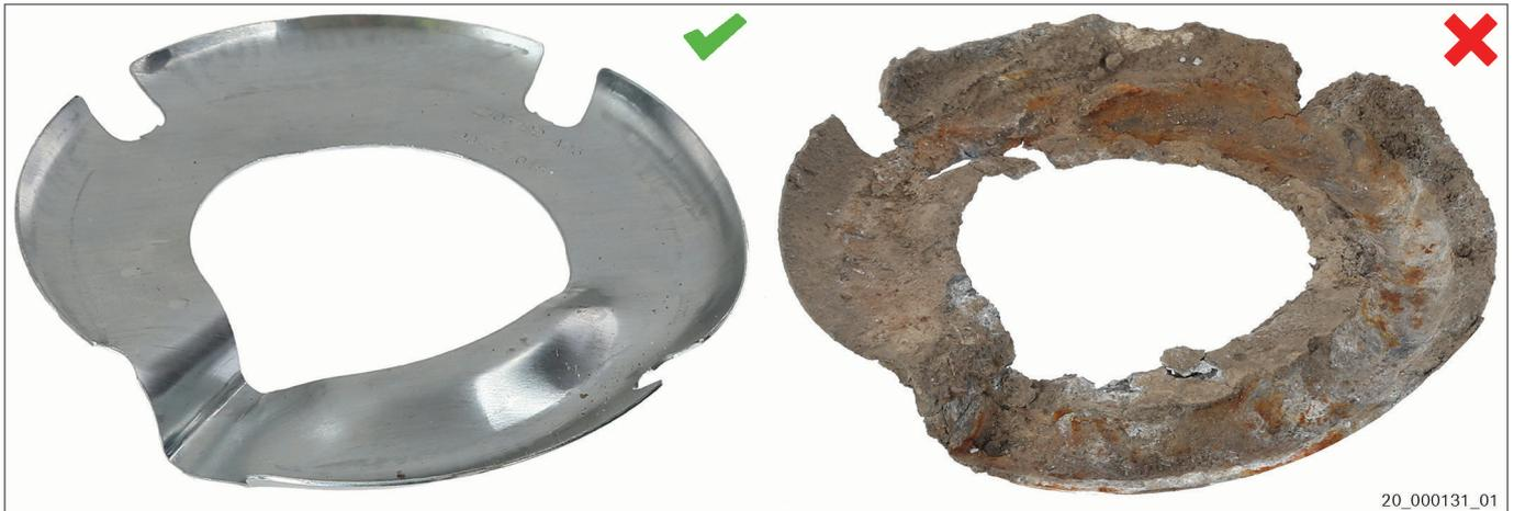
Fig. 3 Anodo anticorrosione nuovo | Anodo anticorrosione usato
